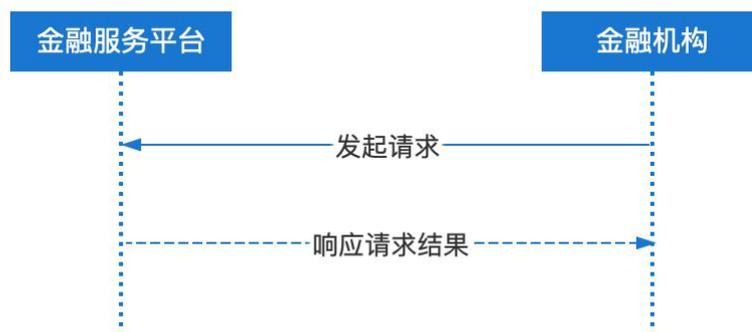
图 10 金融机构注销结果通知接口流程示意图
